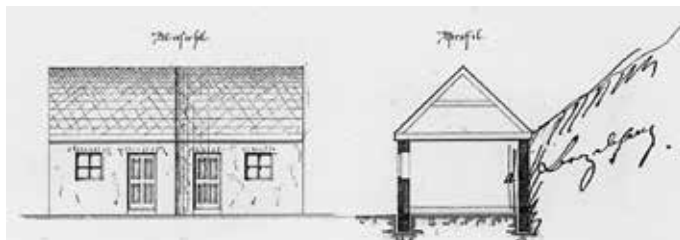
Aus Plänen von 1859 für zwei rückwärtige Kammern. Im Profil sieht man gut, wie der Bergabhang gegen die Rückwand des Häuschens drückt.
